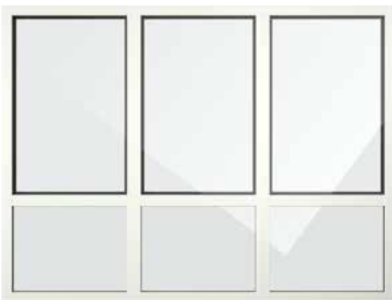
Fenêtre bandeau à six ouvertures, dont trois châssis ouvrants tout en verre (au-dessus) et trois allèges (châssis fixes)
