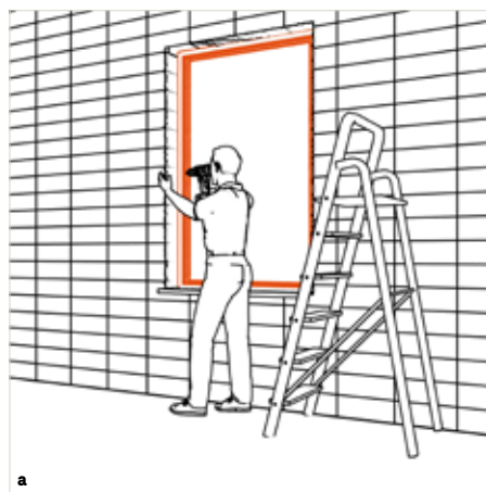
a Le cadre dormant est monté directement sur la maçonnerie pendant la phase de gros œuvre.
